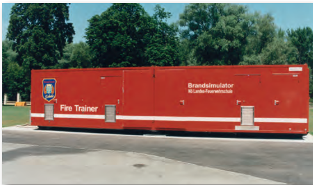
Abb. 10 Brandsimulator, Doppelcontainer mit Gastechnologie
